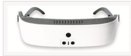
Las gafas eSight son un dispositivo que se usa en la cabeza y que ayuda a mejorar la visión baja con el apoyo de su tecnología: una cámara de alta velocidad y un software de procesamiento de video.
